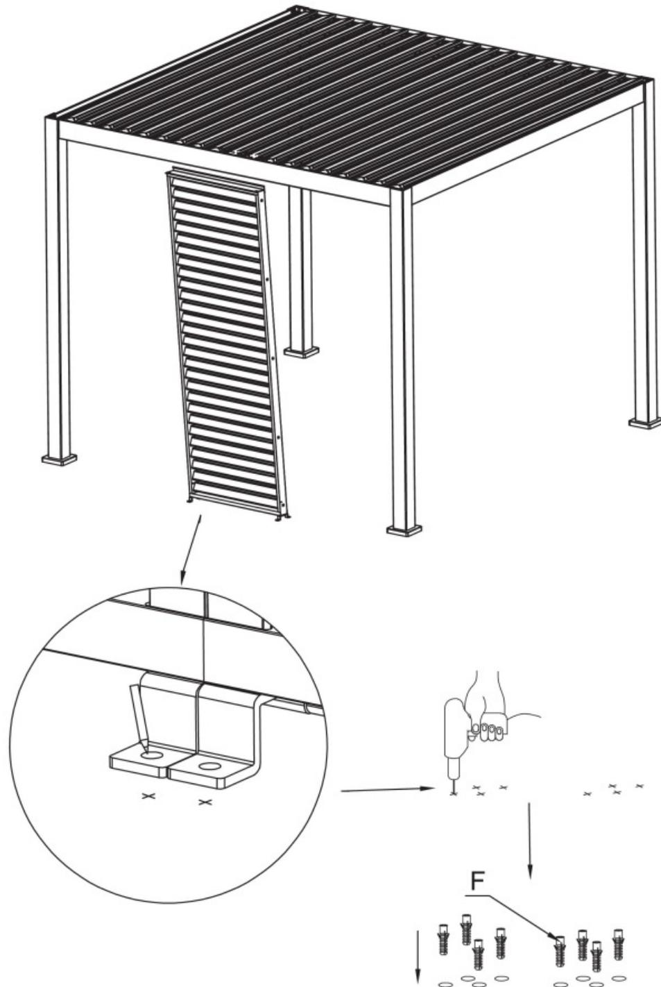
Die Wand senkrecht ausrichten und mit einem Stift die Löcher markieren. Bohrungen im Untergrund vornehmen und mit Dübeln und Schrauben E fest verschrauben. Bei Holzboden sind keine Dübel notwendig.
